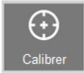
Lorsque l'on appuie sur le bouton **Calibrer**, les étiquettes situées entre le capteur d'étiquette et le bord de la plaque de décollement sont alimentées. Le système mesure ces étiquettes et garde l'information en mémoire. Vous devez calibrer chaque tête d'étiquetage active chaque fois que vous changez un rouleau d'étiquettes ou lorsque vous téléchargez une nouvelle recette.
