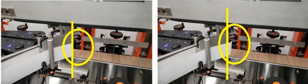
Toutefois, si l'étiquette n'est pas parfaitement alignée avec la plaque de décollement, il faut ajouter (ou soustraire) la distance supplémentaire requise dans le paramètre de **Distance capteur d'étiquette - plaque**.
