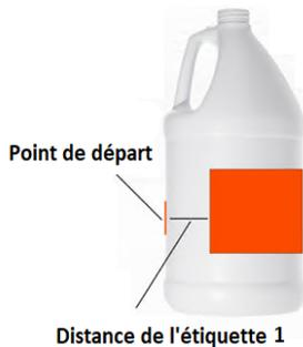
La **Distance d'étiquette 2** est la longueur de la rotation du contenant (à partir du point de départ) avant que le prisme envoie un signal à la tête d'étiquetage de commencer à appliquer la deuxième étiquette.
