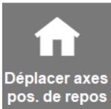
**Déplacer axes pos. de repos** est utilisé pour initier la séquence de déplacements des axes à des fins de test ou pour ramener les axes motorisés à leur position de repos.
