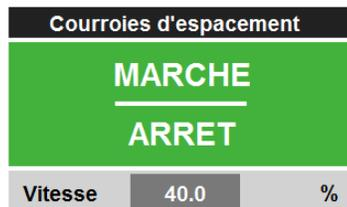
L'interrupteur **MARCHE - ARRÊT** permet de démarrer et d'arrêter le mécanisme d'alimentation. Vous pouvez également ajuster la vitesse du mécanisme d'alimentation directement à partir d'ici, si vos droits d'accès le permettent. Les boutons de commande réguliers du mécanisme d'alimentation se trouvent également dans la sous-section [Modules d'étiquetage](#), avec tous les autres modules d'étiquetage.
