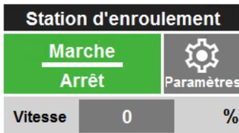
Comme pour les différentes courroies spécialisées, vous pouvez démarrer et arrêter manuellement la station d'enroulement appuyant sur la touche **Marche** et **Arrêt**. Vous pouvez également ajuster sa vitesse en appuyant sur la valeur affichée à l'écran et en saisissant une nouvelle.
