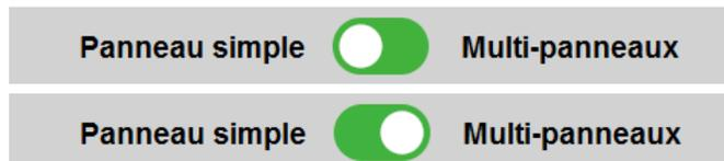
Le mode panneau simple est utilisé lorsque l'étiquette est appliquée en une seule action. Par exemple, si l'étiquette doit être appliquée sur le côté avant, le côté arrière, le dessus ou le dessous du contenant, vous devez sélectionner le mode d'application panneau simple.
