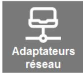
La sous-section **Adaptateurs réseau** est un raccourci vers Windows pour connecter votre système d'étiquetage Nita à votre réseau. La connexion peut se faire via un câble Ethernet RJ45 ou en utilisant le Wi-Fi.
