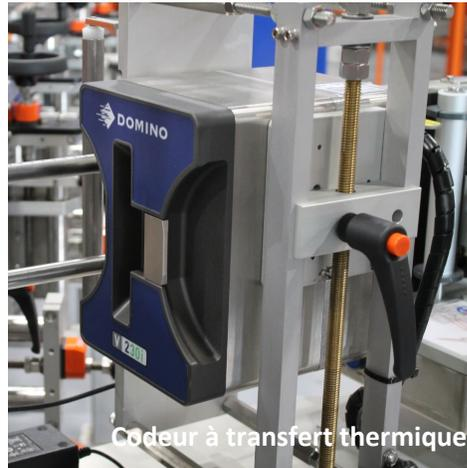
Il est possible d'ajuster la position du codeur.
