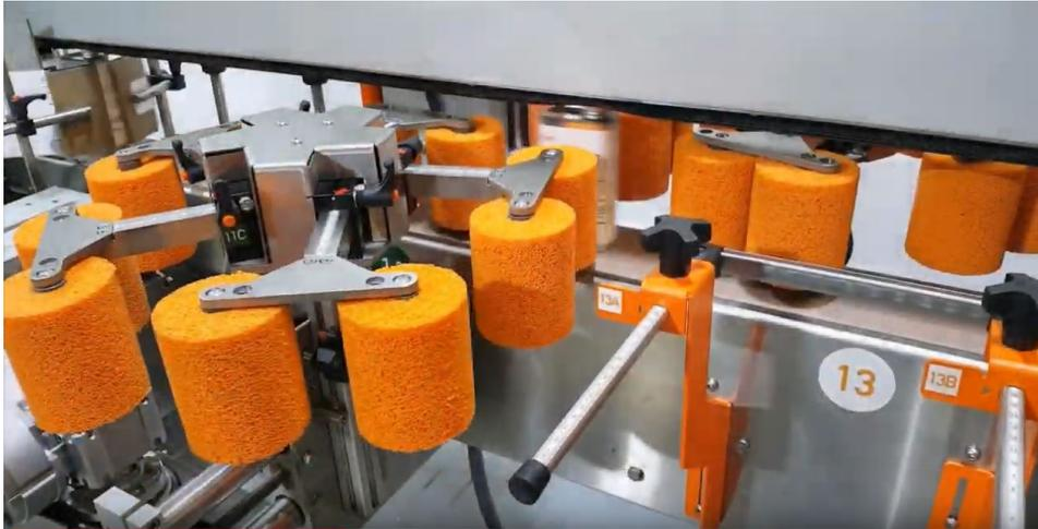
Il est possible d'ajuster la hauteur et la position latérale de l'applicateur rotatif par rapport au convoyeur.
