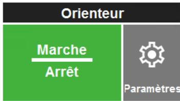
Comme pour les autres composantes, vous pouvez demarrer et arreter manuellement le mecanisme d'orientation en appuyant sur la touche **Marche** et **Arrêt**. Pour la plupart des recettes, le systeme d'orientation (capteurs ou cameras) et les courroies doivent fonctionner simultanement pour que le systeme d'orientation fonctionne correctement.
