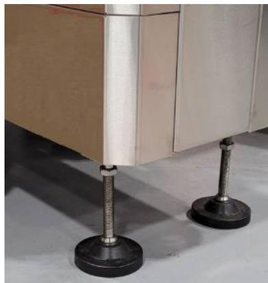
Une fois le système d'étiquetage parfaitement nivelé, connectez l'alimentation et l'air comprimé.
