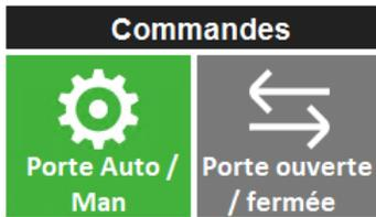
L'interrupteur **Porte Auto / Manuel** permet de mettre la porte en mode automatique ou manuel.
