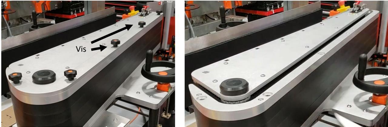
Appuyez sur la goupille de verrouillage puis soulever le cliquet pour relâcher la tension de la courroie de la station d'enroulement. Retirez ensuite la courroie.
