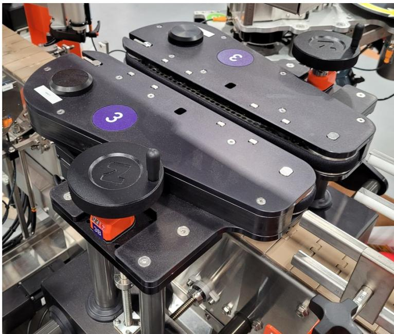
La vitesse de ces courroies d'alignement est synchronisee avec le convoyeur.
