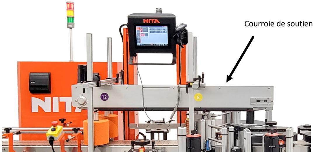
La courroie de soutien peut être réglée en hauteur à l'aide de la manivelle. Le réglage idéal est lorsqu'il y a une pression suffisante pour empêcher le contenant de bouger, mais en évitant de l'aplatir ou de le déformer.
