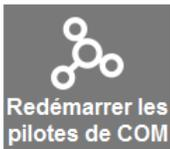
Si vous cliquez sur le bouton **Redémarrer les pilotes de COM**, le système réinitialisera les pilotes de communication entre l'HMI et les contrôleurs et affichera le message suivant:
