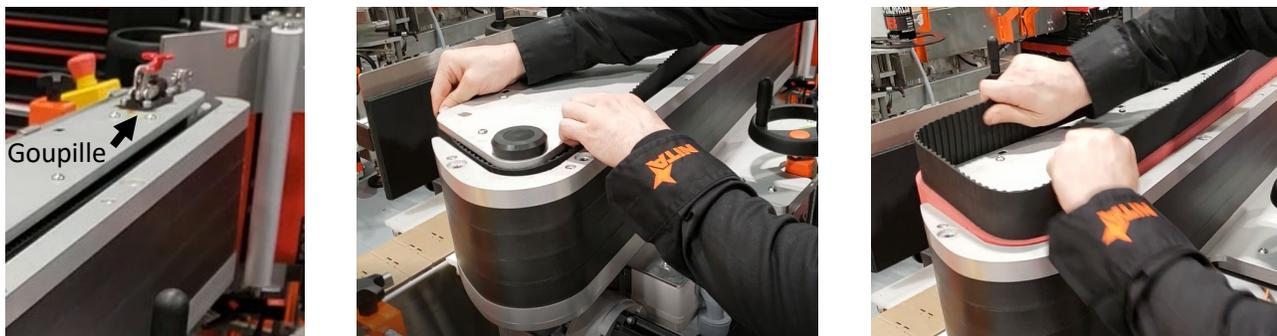
Installez la nouvelle courroie en pointant la flèche vers la sortie de la machine. Assurez-vous que les dents de la courroie sont correctement alignées avec les sillons.
